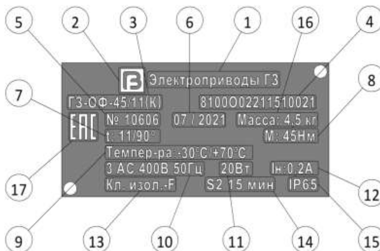
Рисунок 2 – Заводская табличка электропривода (пример)
